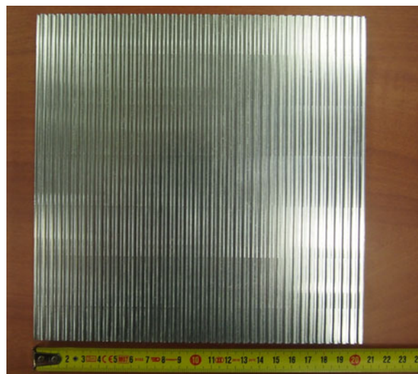
Fig. 6. Fabricated 80 -groove array ( 200 \text{ mm} \times 200 \text{ mm} ).
