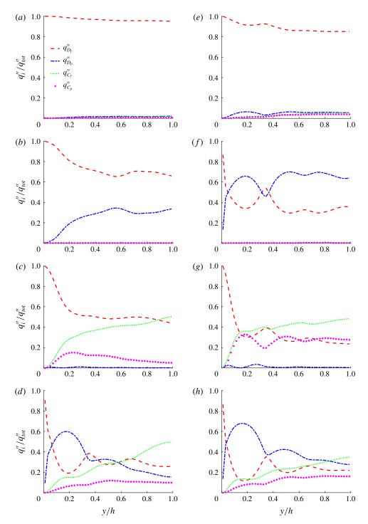
FIGURE 13. (Colour online) Heat flux budget for the volume fractions  $\phi=10\%$ : (a)  $Re_p=0.5, \Gamma=0.1$ ; (b)  $Re_p=0.5, \Gamma=10$ ; (c)  $Re_p=16, \Gamma=0.1$ ; (d)  $Re_p=16, \Gamma=10$ ; and  $\phi=30\%$ : (e)  $Re_p=0.5, \Gamma=0.1$ ; (f)  $Re_p=0.5, \Gamma=10$ ; (g)  $Re_p=16, \Gamma=0.1$ ; (h)  $Re_p=16, \Gamma=10$ .
