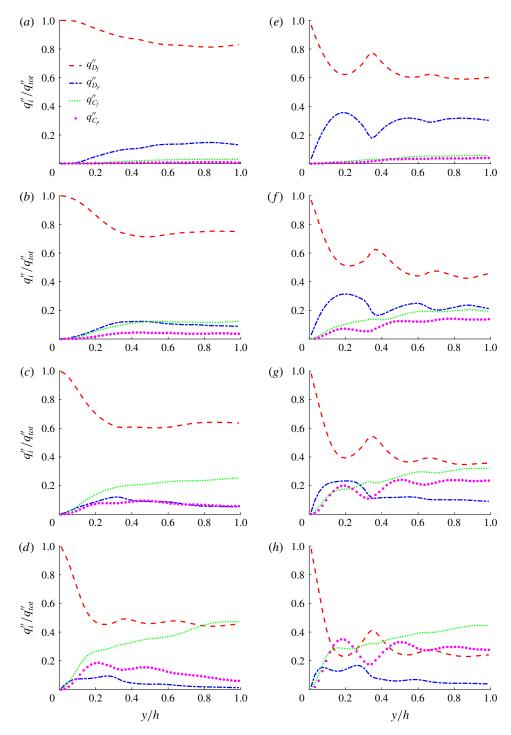
FIGURE 10. (Colour online) Heat flux budget for the volume fractions  $\phi = 10\%$ : (a)  $Re_p = 1$ ; (b)  $Re_p = 4$ ; (c)  $Re_p = 8$ ; (d)  $Re_p = 16$ ; and  $\phi = 30\%$ : (e)  $Re_p = 1$ ; (f)  $Re_p = 4$ ; (g)  $Re_p = 8$ ; (h)  $Re_p = 16$ .
